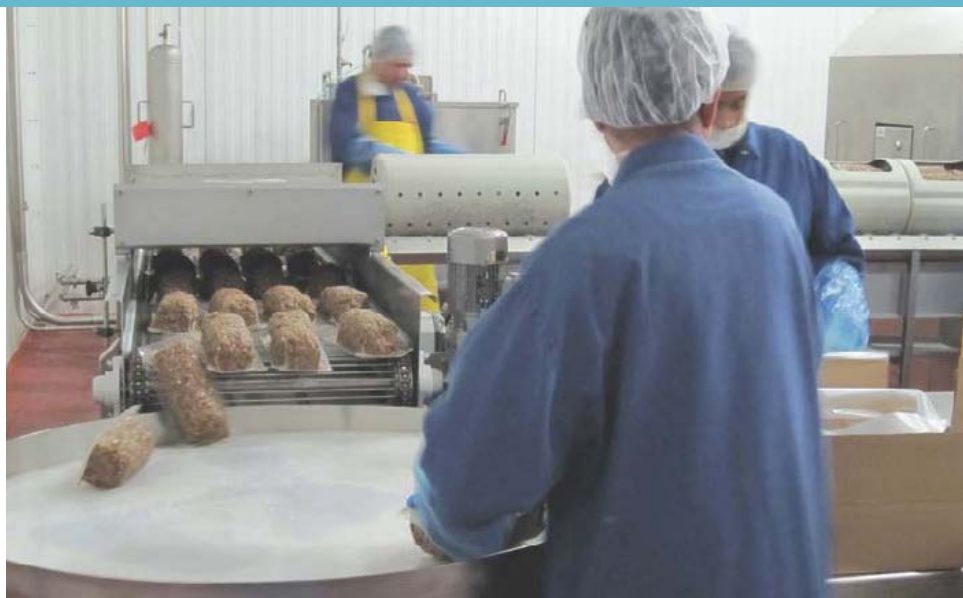
Avure a installé chez Astra Foods (États-Unis), un système hautes pressions 350 l pour le traitement de viandes destinées aux sandwiches et préparations chaudes, particulièrement appréciés aux États-Unis.
